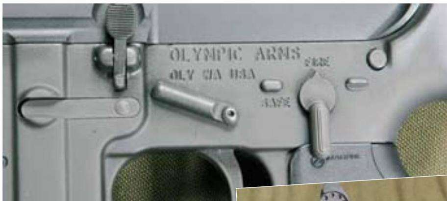
A sinistra: le spine passanti sono state sostituite da altre prodotte dalla Kns precision con sistema anti rotazione, in modo da evitare l'usura delle sedi nel tempo.
