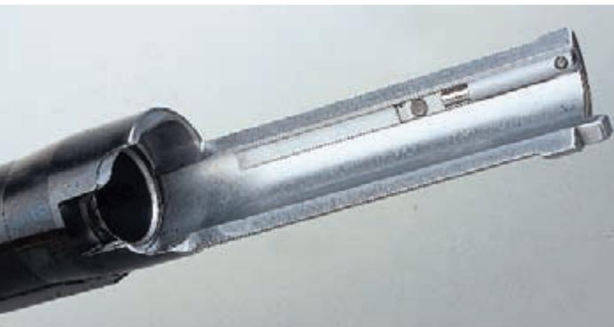
A sinistra: la culatta, piuttosto allungata, è costruita in acciaio speciale e può essere sostituita. Nella porzione anteriore, sui lati, si notano le sedi delle alette dell'otturatore che garantiscono la chiusura. Nella parte terminale è visibile il dente di espulsione. A destra: la canna è vincolata anteriormente al prolungamento del tappo del serbatoio ed è trattenuta in sede da una ghiera a vite.
